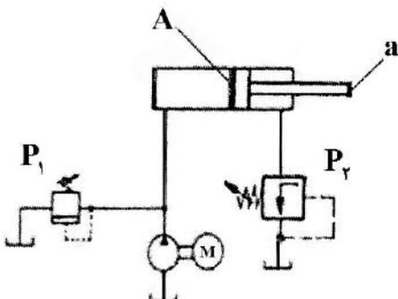
۱۲۹- در مدار شکل زیر مساحت پیستون A و مساحت میله  $\frac{A}{۲}$  و دبی پمپ Q است. فشار تنظیم شیرهای اطمینان نیز مشخص شده است. فلومتر، دبی خروجی از سیلندر را  $\frac{Q}{۳}$  نشان می‌دهد. در وضعیت نشان داده شده، توان اتلافی از شیر کنترل جریان کدوم است؟
